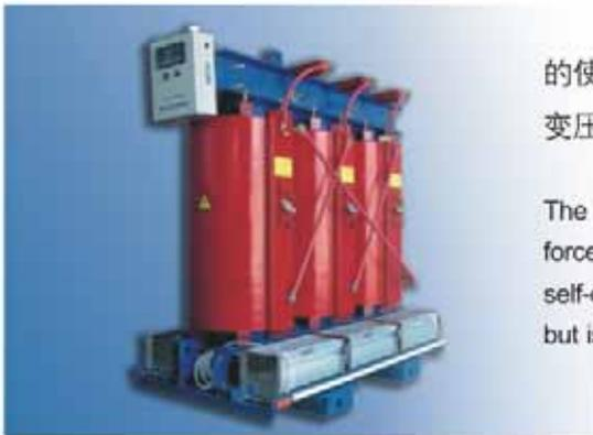
采用空气自冷(AN)和强迫风冷(AF)两种冷却方式。辐流式风冷装置的使用可使变压器增容40%。风冷装置仅作为短时过载的保护，不推荐变压器长期在强迫风冷方式下工作。
