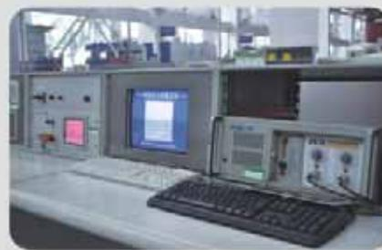
变压器性能测试系统
